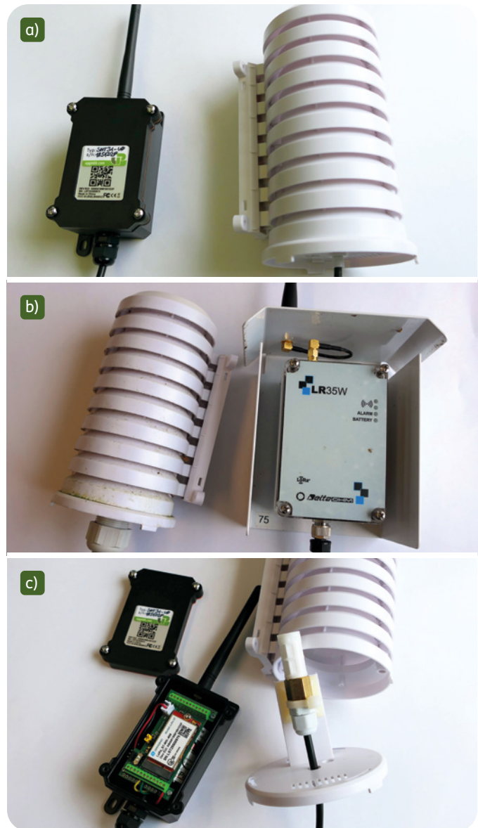
Abb. 3: a) Logger mit Messgerät, b) Sensor mit Messgerät, c) Detailaufnahme Messgerät und Sensor; eigene Aufnahmen
