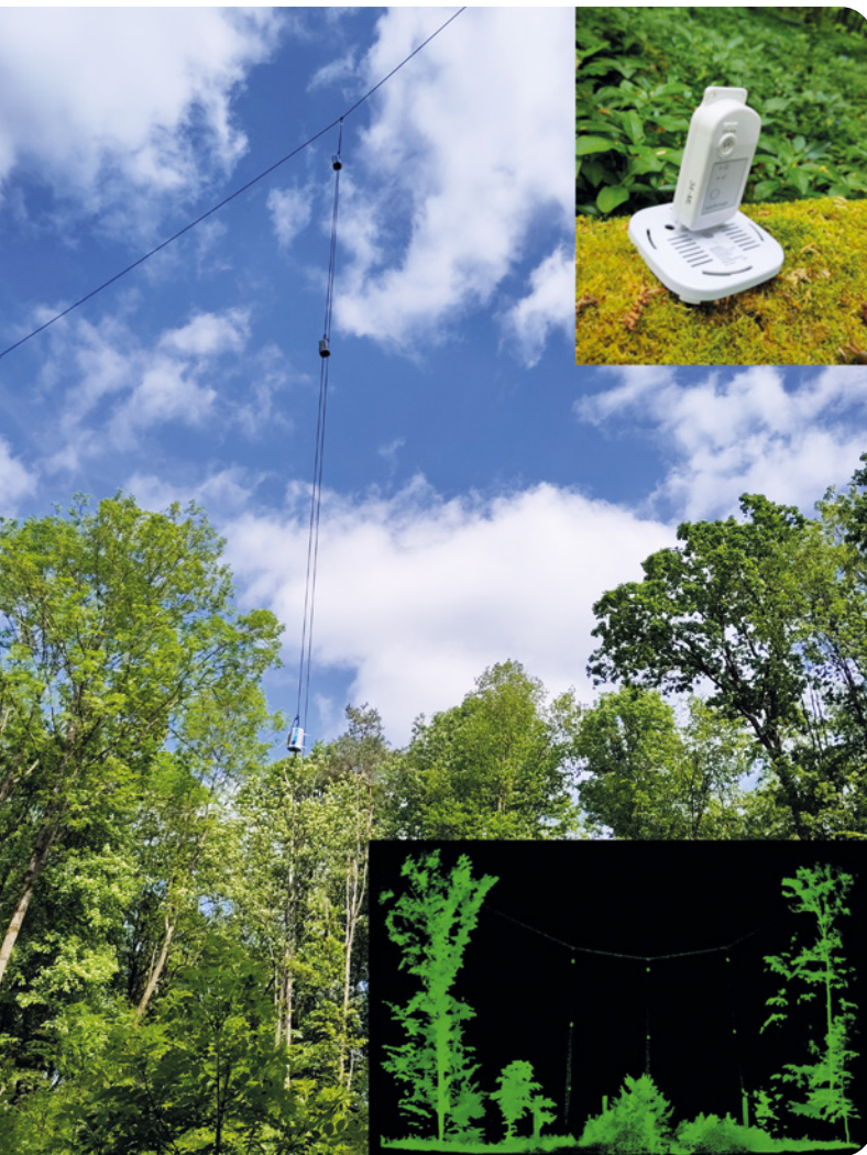
Abb. 1: Mikroklima-Messungen: Ein vertikales Profil mit drei Luftfeuchte- und Temperatursensoren am Seil, ein Sensor in Nahansicht und Seilinstallationen in einer digitalen Punktwolke.
