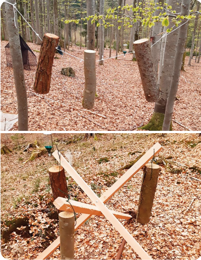
Abb. 7.1: Standardisiertes Holz, teilweise aufgehängt und teilweise auf dem Boden ausgelegt, um den Massenverlust des Holzes sowie die mikrobiellen Gemeinschaften zu bewerten.
