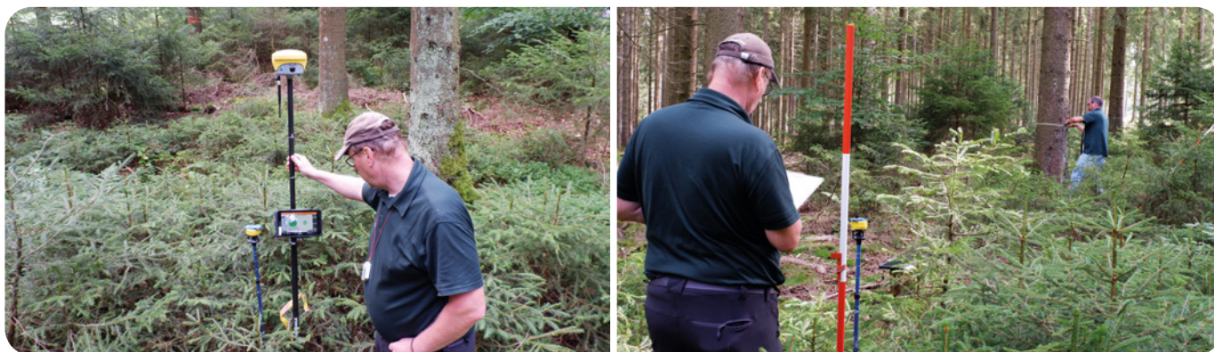
Abb. 1: Einmessung und Vermarkung des Probekreisentrums des Stichprobenpunktes (links). Erfassung von Probebäumen innerhalb des Probekreises (rechts). Foto: Landesforsten Rheinland-Pfalz.
